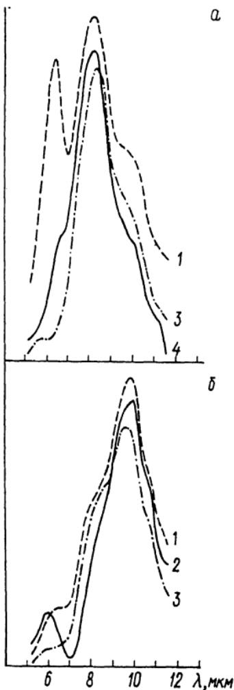
Спектральная зависимость интенсивности прошедшего через фильтр излучения до (а) и после нанесения (б) просветляющих покрытий в различных магнитных полях  $H$  и  $T = 80$  К.
