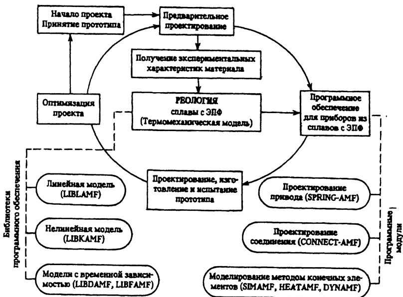
Рис. 1. Процесс проектирования устройств из сплавов с эффектом памяти формы.
