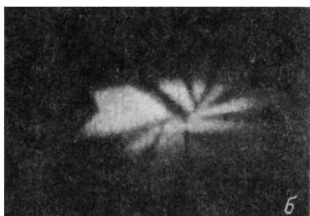
Рис. 3. Исходное изображение объекта, наблюдаемое сквозь решетку G (а), и изображение объекта, восстановленное селектограммой (б).
