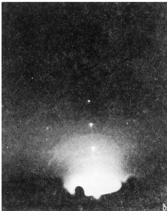
Рис. 3. Электронограмма, снятая на отражение с поверхности кремния, облученного ионами неона \text{Ne}^+ дозой 1.85 \cdot 10^{17} \text{ см}^{-2} , с энергией 40 кэВ после травливания слоя 900 Å.
