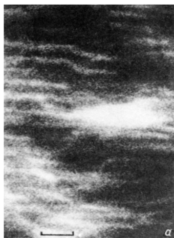
Рис. 5. Фотография в СЭМ поверхности эпитаксимального слоя кубического GaN на подложке GaAs (001). Толщина слоя: а — 10 \div 20 нм; б — 0.5 \div 1.0 мкм.
