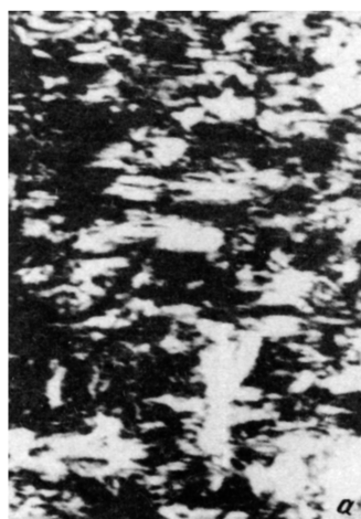
Рис. 6. Результаты ПЭМ для сплошного слоя кубического GaN на подложке GaAs (001), средняя толщина слоя 20 нм. а — темнопольное изображение в рефлексе (200) GaN; б — микродифракционная картина.
