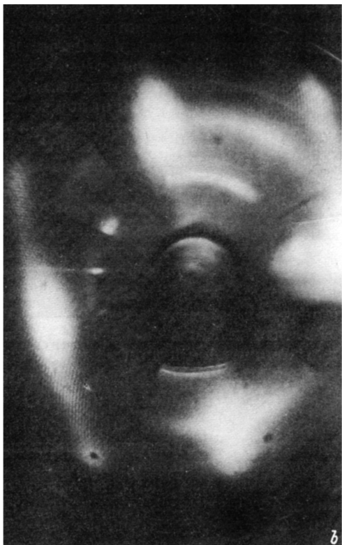
Рис. 4. Картины ДМЭ для слоев кубического GaN/GaAs (001). Толщина слоя GaN: a — 10÷20 нм; b — 0.5÷1.0 мкм. Энергия электронов — 48 эВ.
