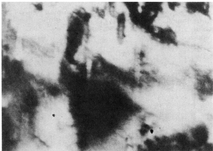
Рис. 4. Электронно-микроскопическая картина на просвет в сечении (0001) при деформации монокристаллов пирамидальным скольжением.
