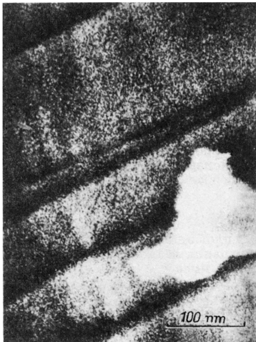
Рис. 6. Изображение поверхности Ge (111) в сканирующем электронном микроскопе после разрушения образца напряжением \sigma = 10^9 Pa.
