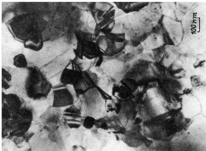
Рис. 1. Микрофотография структуры германия, подвергнутого интенсивной пластической деформации и отжигу при температуре 850 °С.
