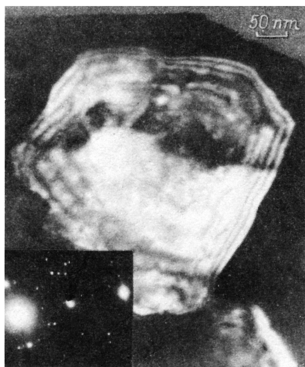
Рис. 5. Темнопольное изображение полосчатого контраста на ГЗ.
