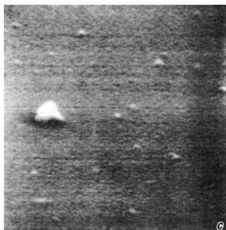
Рис. 3. Изображение пленки фуллера на кремниевой подложке (100) в растровом электронном микроскопе (РЭМ) при различных толщинах.
