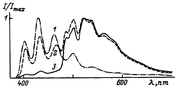
Рис. 1. Спектры люминесценции системы бензальдегид-1-бромнафталин в этаноле при T = 100 К.
