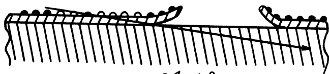
Рис. 5. Трек в островковой пленке золота на свободной поверхности тонкой пленки углерода ( \alpha ). Оторванные кусочки углеродной пленки с участка поверхности над траекторией иона ( \beta ).
