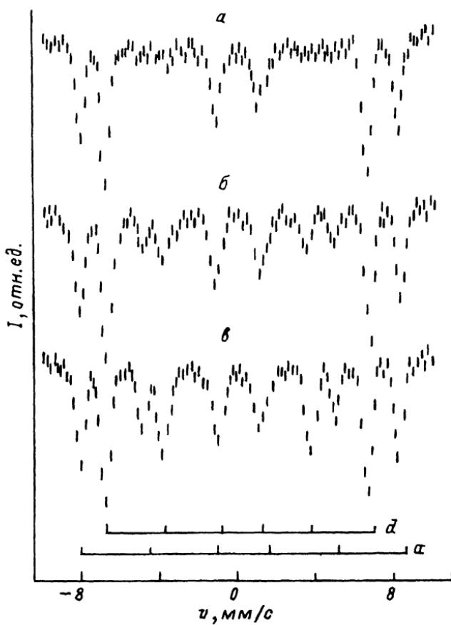
Мессбауэровские спектры монокристаллической пластинки феррита  $\text{Gd}_3\text{Fe}_5\text{O}_{12}$  в области  $T_{\text{k}}$ :
