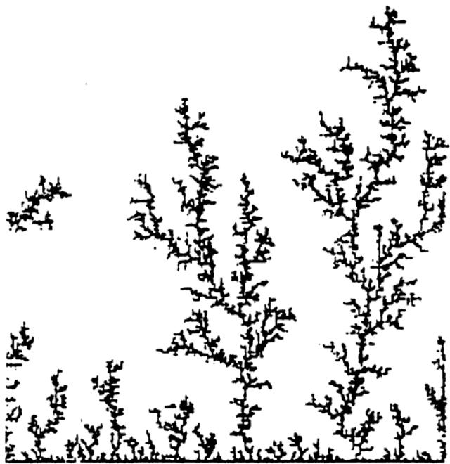
Картина электрохимического пробоя гидратированного оксида иридия как аналог двумерного пробоя диэлектриков [10]. Показаны окрашенные микрообласти и критический кластер (справа).
