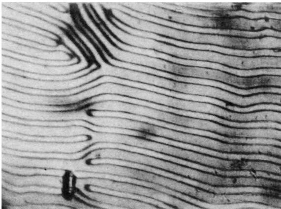
Рис. 2. Фотография доменной структуры размагниченной пленки феррита-граната типа (210), полученная при светлопольном освещении и в скрещенных анализаторе и поляризаторе.
