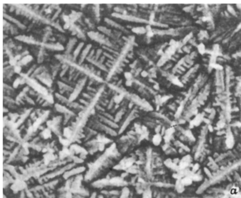
Рис. 2. Морфологические изменения микрорельефа на GaAs (100) в процессе анизотропного травления. Время травления: а — 1с, б — 3 мин.
