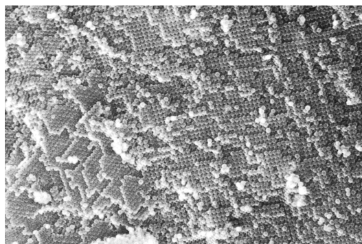
Рис. 1. СЭМ-изображение тонкого скола опаловой матрицы.
