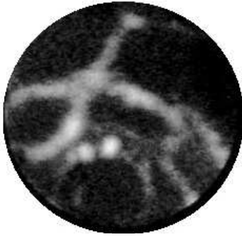
Рис. 1. Полевое электронное изображение иридиевого эмиттера с пленкой графена ( V = 6300 \text{ V} ).
