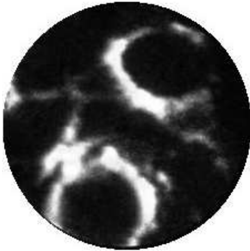
Рис. 2. Полевое электронное изображение иридиевого эмиттера с пленкой графена, интеркалированной атомами цезия ( V = 5500 \text{ V} ).
