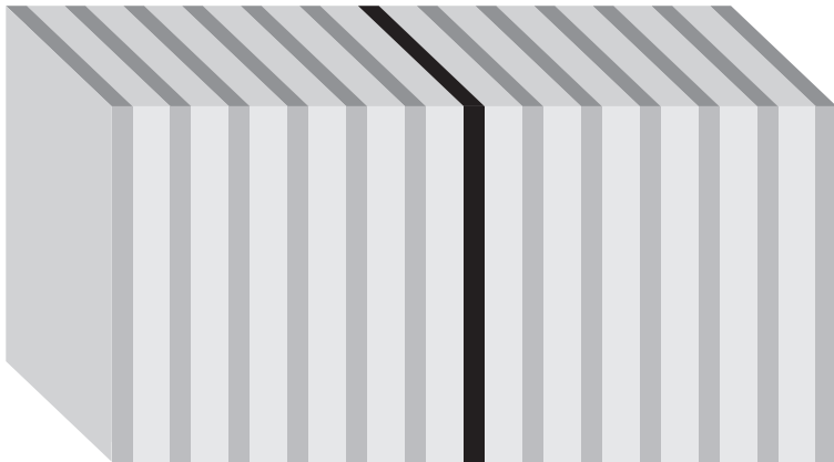
Рис. 1. Схема резонатора Фабри-Перо с квантовой ямой. Параметры квантовой ямы: борковский радиус экситона a_{ex} = 10 nm, ширина квантовой ямы d = 15 nm, продольно-поперечное расщепление экситона \hbar\omega_{LT} = 0.1 meV, нетрадиционное затухание \Gamma = 0.5 meV, радиационное затухание \Gamma_0 = 50 \mu eV (согласно данным [6,10]). Параметры резонатора: диэлектрические проницаемости и толщины слоев соответственно \varepsilon_1 = 5 , d = 70 nm, \varepsilon_2 = 3 , d_2 = 140 nm, количество периодов 6.
