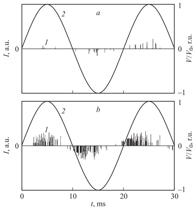
**Рис. 2.** Частичные разряды на первых трех полупериодах напряжения (кривые 1). Приложенное напряжение (кривые 2). *a* —  $V_0 = 10$ ,  $N = 70$ ; *b* —  $V_0 = 20$ ,  $N = 75$ .
