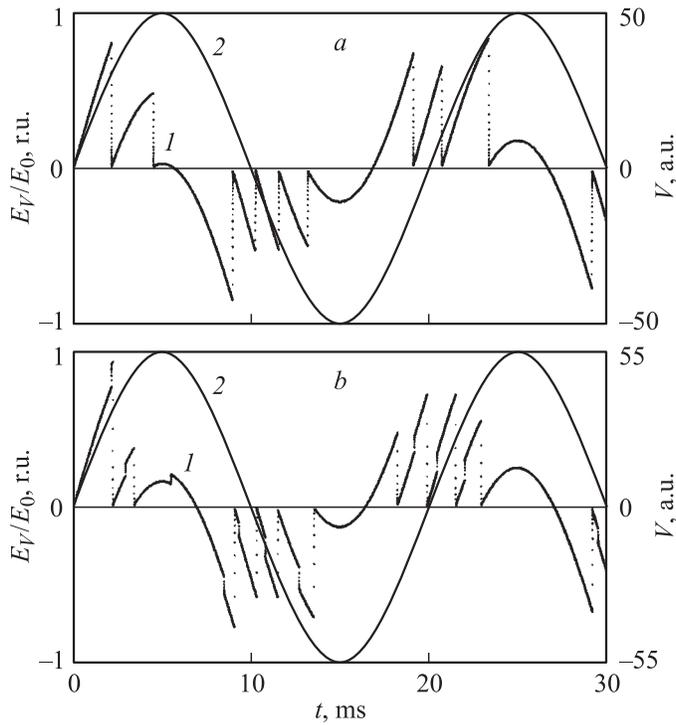
**Рис. 3.** Относительная величина электрического поля (кривые 1): *a* — внутри одиночной каверны, находящейся в твердом диэлектрике,  $V_0 = 50$ ; *b* — внутри одной из спаренных каверн,  $V_0 = 55$ . Приложенное напряжение (кривые 2).  $\epsilon = 2$ .
