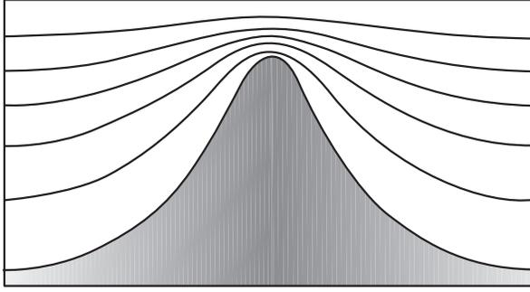
Один период стационарного профиля свободной заряженной поверхности проводящей жидкости для  $k = 0.2$  и  $u = 1.8$ . Приведены также эквипотенциальные поверхности  $\varphi = 0.3, 0.6, 0.9, 1.2, 1.5$ .
