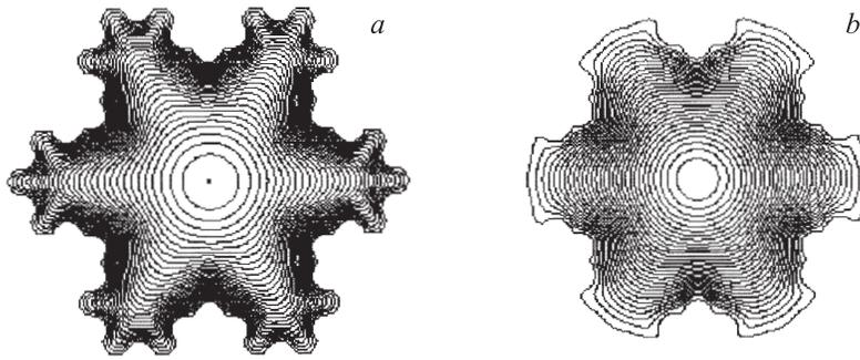
**Рис. 2.** Линии уровня функции области предфрактала острова Коха 3-го порядка (а) и основного типа волны  $E_{01}$  (b).
