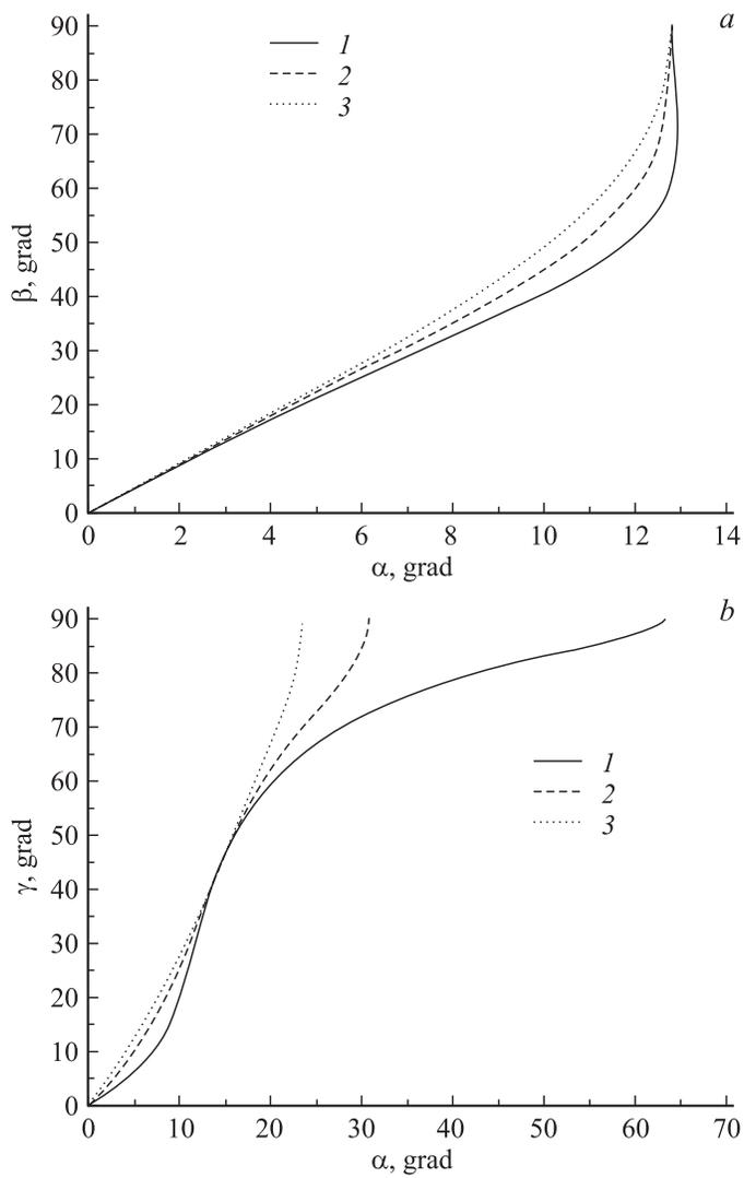
**Рис. 2.** Зависимость углов преломления  $\beta$  (a) и  $\gamma$  (b) соответственно  $LA_2$  и  $TA_2$  МАВ от угла падения  $\alpha$   $LA_1$ : 1 —  $H = 100$  Oe ( $\xi = 0.840$ ), 2 —  $H = 500$  Oe ( $\xi = 0.507$ ), 3 —  $H = 2000$  Oe ( $\xi = 0.194$ ).
