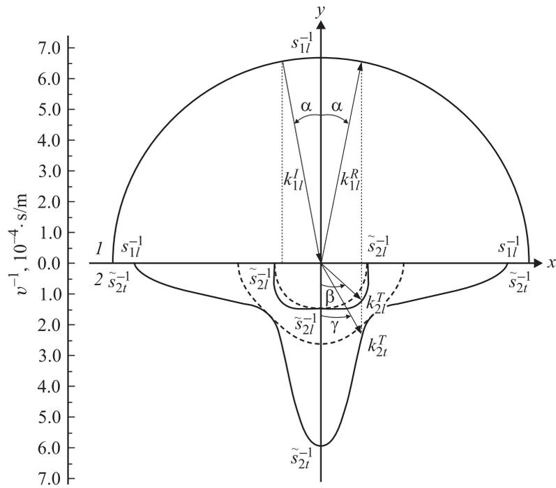
**Рис. 1.** Геометрическое построение волновых векторов для волн падающей, отраженной и преломленных на границе вода–гематит. Сплошная линия —  $H = 100$  Oe, штриховая —  $H = 2000$  Oe.
