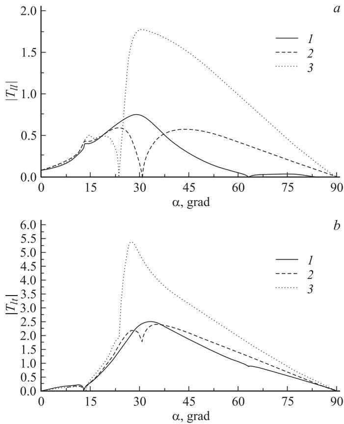
**Рис. 3.** Зависимость модулей коэффициентов прохождения  $T_{ll}$   $LA$  ( $a$ ) и преобразования  $T_{lt}$  в  $TA_2$  ( $b$ ) на границе вода–гематит от угла падения  $LA_1$   $\alpha$ : 1 —  $H = 100$  Ое, 2 —  $H = 500$  Ое, 3 —  $H = 2000$  Ое.
