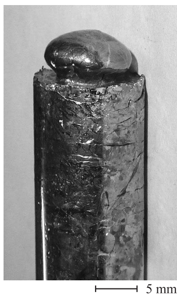
Рис. 1. Вид стержня из висмута, полученного при кристаллизации в цилиндрическом кристаллизаторе.
