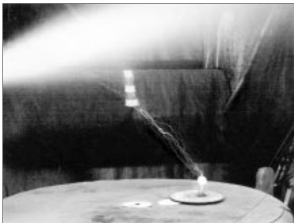
Рис. 2. Группа модельных гидрометеоров инициирует разрядные явления вблизи границ облака заряженного аэрозоля.
