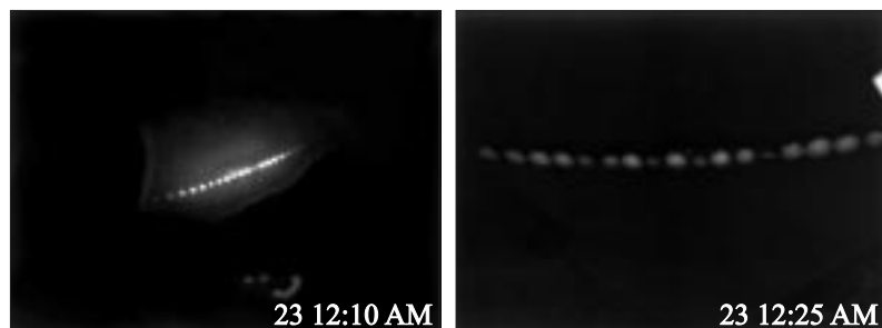
Рис. 8. Распределение интенсивности прошедшего и отраженного пучка линзой с дифракционной решеткой.
