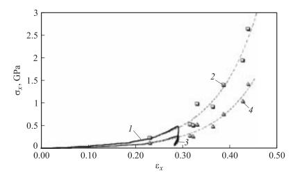
Единые кривые сжимаемости песка в осях  $\sigma_x \sim \varepsilon_x$  (1 и 2) и в осях  $P \sim \varepsilon_x$  (3 и 4).
