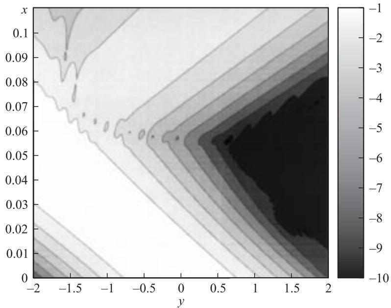
**Рис. 2.** Изолинии  $\log_{10}(|u|)$  при расчете с граничными условиями Баскакова–Попова [3].
