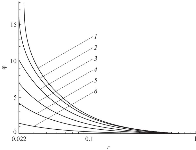
**Рис. 1.** Распределение электростатического потенциала  $\varphi(r)$  вокруг макрочастицы для условий эксперимента [10] при нескольких значениях параметра  $\delta$ : 1 —  $\delta = 0$ , 2 — 0.1, 3 — 0.28, 4 — 0.5, 5 — 0.7, 6 — 0.9.
