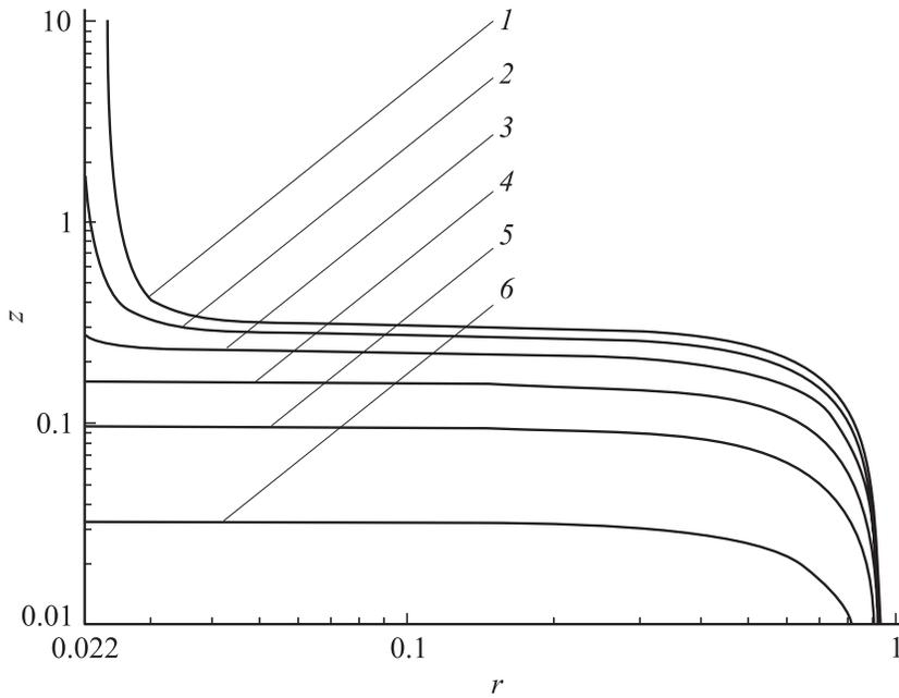
**Рис. 2.** Заряд  $z(r)$  внутри сферы радиуса  $r$  для условий эксперимента [10] при нескольких значениях параметра  $\delta$ , обозначения как на рис. 1.
