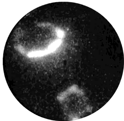
Рис. 4. Полевое электронное изображение графена на иридии при адсорбции цезия.
