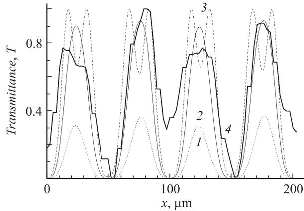
Рис. 4. Расчетные (1–3) и экспериментально полученная (4) стационарные зависимости пропускания линейно поляризованного света от поперечной координаты  $x$ .
