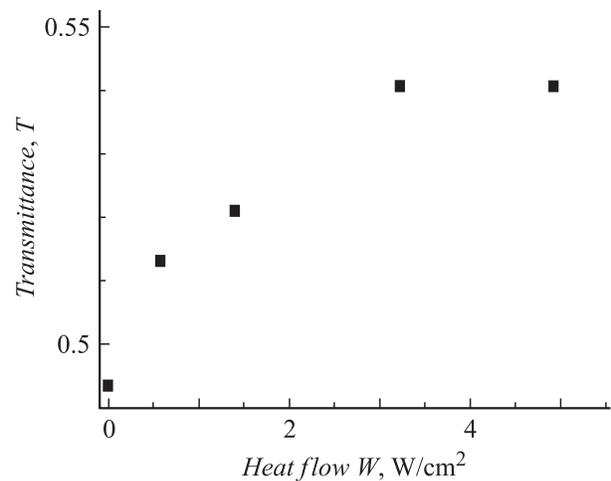
Рис. 5. Экспериментальная зависимость прозрачности образца от теплового потока  $W$ .
