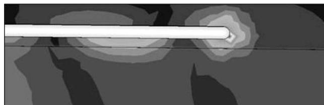
**Рис. 13.** Распределение амплитуды электрического поля около головы одного из „стримеров“ в плоскости  $x = 0$ . Черная линия — граница диэлектрической антенны.
