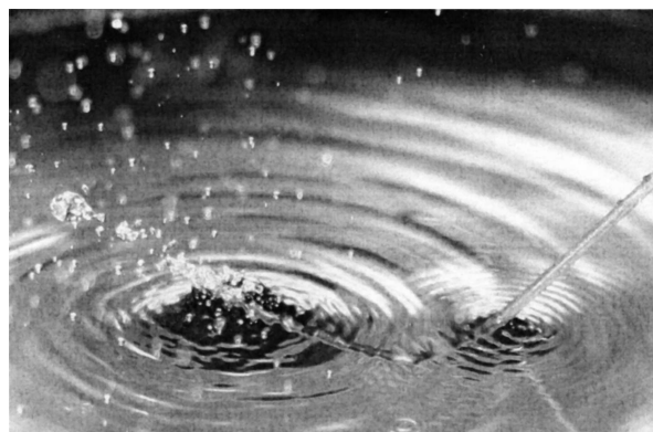
Рис. 5. Возбуждение стержнем капиллярных волн на поверхности жидкости.
