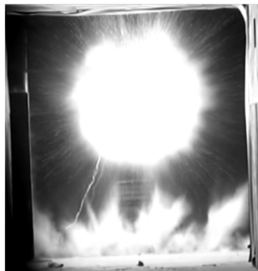
Рис. 5. Видеокадр срабатывания взрывного генератора. Диаметр тела свечения \sim 1.2 м.
