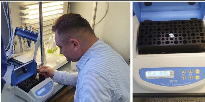
Рис. А4. Подсушивание на прецизионной печи алиquotы на воздухе при нормальном атмосферном давлении и температуре  $T \leq 40 \text{ }^\circ\text{C}$  в течении 10 минут.
