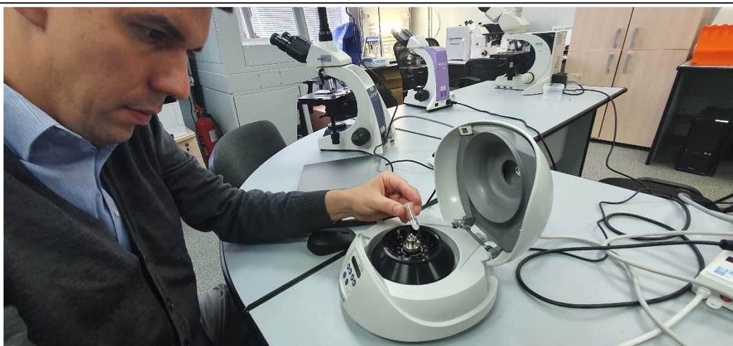
Рис. А3. Промывание соскоба в буферном растворе, помещение смеси в пробирку и её центрифугирование в течении 5 мин на 5000 оборотов/мин<sup>-1</sup>.
