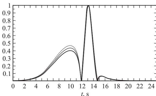
**Рис. 5.** Зависимость от времени  $t, s$  нормированных на максимум следующих величин: амплитуда сигнала  $A(t)/A_{\max}$  (нижняя кривая наибольшей толщины), преобразование ГТ  $|g_W(f_0; t)|/|g_{\max}(f_0; t)|$  для  $W = 0.2$  s (средняя кривая промежуточной толщины), преобразование SWT  $|V(f_0; t)|/|V_{\max}(f_0; t)|$  (тонкая кривая).
