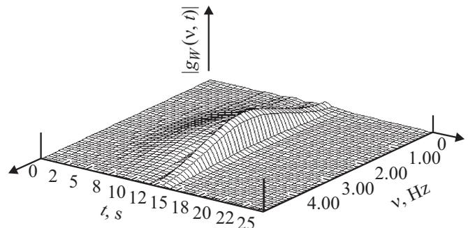
**Рис. 2.** Модуль ГТ  $|g_W(\nu, t)|$ , построенный для сигнала  $Z(t)$  (рис. 1), в зависимости от частоты  $\nu, \text{ Hz}$  и времени  $t, \text{ s}$  для ширины окна  $W = 0.1 \text{ s}$ .
