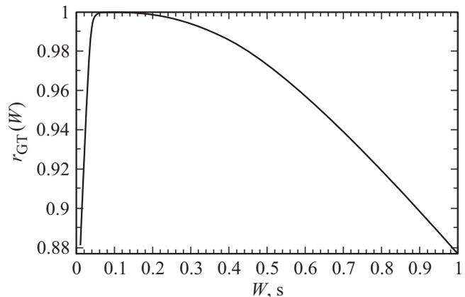
Рис. 4. Зависимость коэффициента корреляции Пирсона  $r_{GT}(W)$  (13) между амплитудой сигнала  $A(t)$  (7) и модулем преобразования GT  $|g_w(f_0, t)|$  (10) от размера окна  $W$ , s.
