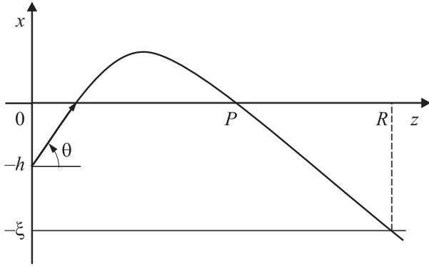
Рис. 2. Траектория частицы в плоскости симметрии поля с учетом дрейфового пространства.
