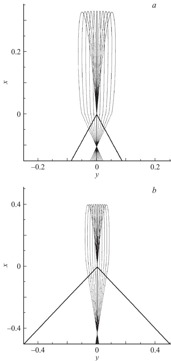
**Рис. 6.** Поперечная фокусировка в полях с различными показателями  $n$ :  $a$  —  $3/5$ ;  $b$  —  $2/3$ . Начальные условия движения частиц:  $x_0 = 0.001$ ,  $y_0 = 0$ ,  $W = 0.5$ ,  $-5 < \alpha < 5^\circ$ .
