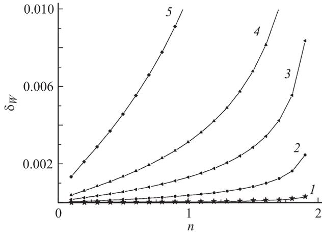
Рис. 5. Удельная дисперсия в условиях фокусировки II порядка для пучков с разным разбросом начальных углов  $2\Delta\theta$ : 1 — 2, 2 — 4, 3 — 6, 4 — 8, 5 — 12°.
