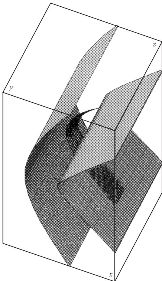
**Рис. 10.** Конструкция двумерного электронного спектрографа с плоскостью симметрии и траектории частиц в нем.
