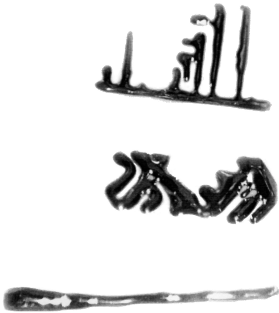
Рис. 2. Морфология микрокристаллов ВСМ, образующихся в объеме раствора-расплава ВСМ–Sn.
