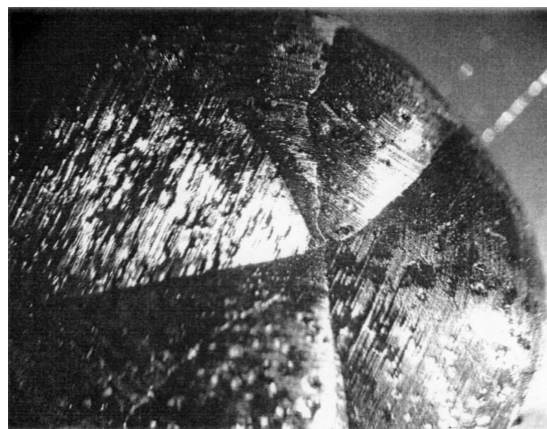
Рис. 1. Поверхность „линзы“ ВСМ со стороны раствора-расплава ВСМ–Sn.
