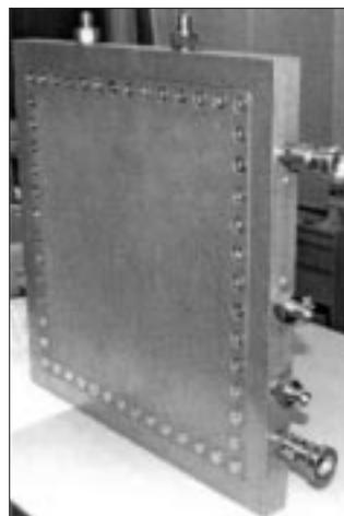
Рис. 1. 2D-монитор тепловых нейтронов.
