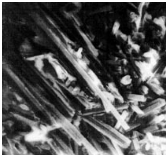
Рис. 5. Микрофотография среза PDPO, наполненного 35 vol,% отрезков стеклянных волокон.
