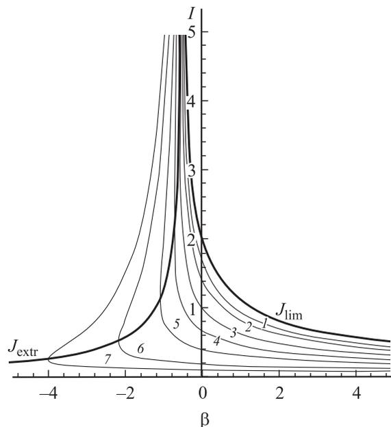
Зависимость  $J(\beta)$  при различных  $k$ : 1 — 10, 2 — 5, 3 — 2, 4 — 1, 5 — 1/2, 6 — 1/5, 7 — 1/10; жирные линии — графики  $J_{\text{lim}}(\beta)$  и  $J_{\text{extr}}(\beta)$ .
