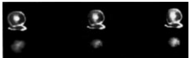
Рис. 7. Фрагменты кадровой сверхскоростной фоторегистрограммы плазменного тороидального вихря и не захваченного в вихревое движение шаровидного плазменного облака при \Pi < \Pi_0 и t > \Delta t_u > \tau_b . Длительность кадра 40\ \mu\text{s} , время между кадрами 40\ \mu\text{s} .
