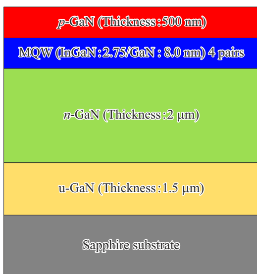
Рис. 1. Схематическое изображение светодиодной InGaN/GaN-гетероструктуры.
