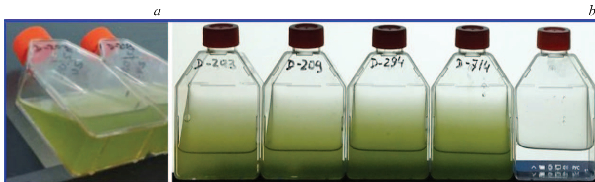
Рис. 7. Вид флаконов с культурами микроводорослей на наклонном экране монитора ноутбука для реализации способа „слоя переменной толщины“ методом ЦФ сбоку (а) и сверху (b).
