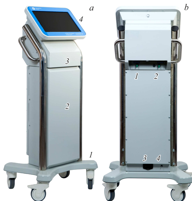
Рис. 8. a — фотография аппарата спереди: 1 — основание, 2 — блок генерации и ПГС, 3 — блок КГС, 4 — блок СОИ; b — фотография аппарата сзади: 1 — штуцер „Контроль“, 2 — штуцер „Выход NO“, 3 — включатель „220 V“, 4 — штуцер „Сброс“.
