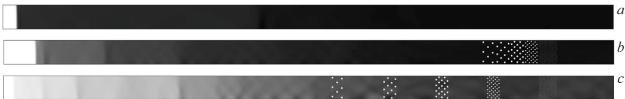
Рис. 2. Расчетные поля давления в плоскости осевого сечения модельного канала для разных моментов времени. a — без пористой преграды при t/t^* = 1 ; b — с преградой 1 при t/t^* = 0.96 ; c — с преградой 2 при t/t^* = 0.74 .
