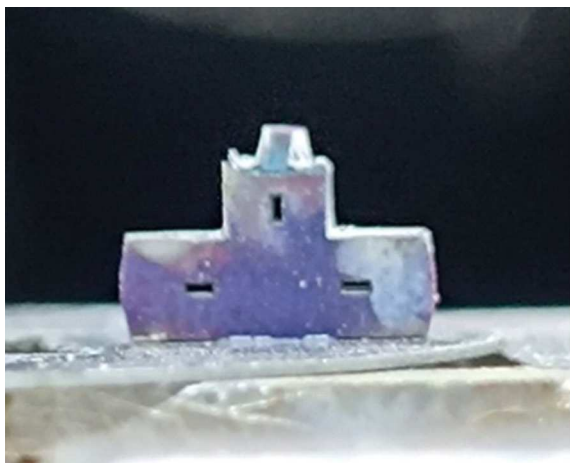
Рис. 6. Фотография заготовки в виде крестовины с изготовленным катодным выступом.
