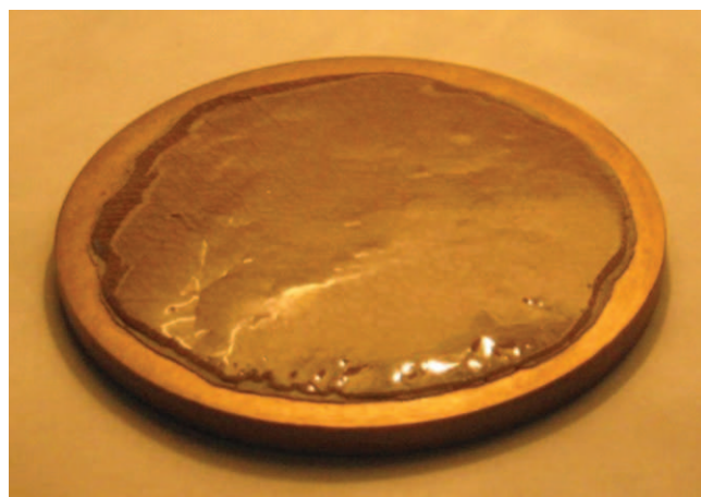
Рис. 1. Монокристалл AlN. Толщина и диаметр кристалла равны соответственно 2.5 и 64 mm. Кристалл был выращен на Si-границы подложки 6H-SiC сублимационным сэндвич-методом, механически отполирован со стороны подложки до ее удаления и приклеен к пластине TaC. Съемка в отраженном свете с боковой подсветкой.
