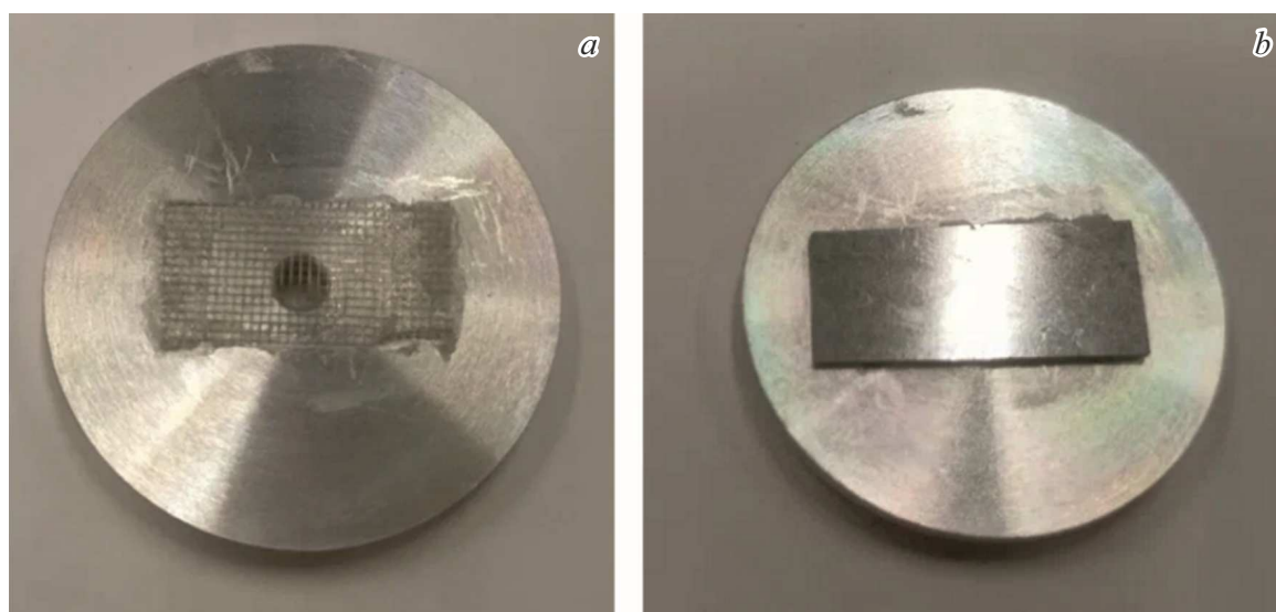
Рис. 5. Фотография держателя образцов: a — с закрепленной маскирующей сеткой; b — с закрепленным образцом.
