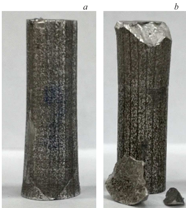
Рис. 2. Фотографии образцов после испытания на удар: а) 219 м/с, б) 243 м/с.
