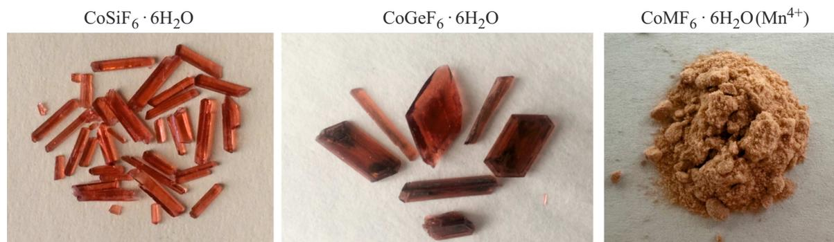
Рис. 1. Фотографии кристаллов и активированного порошка  $\text{CoMF}_6 \cdot 6\text{H}_2\text{O}:\text{Mn}^{4+}$
